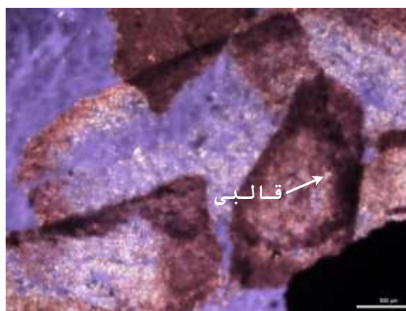
شکل ۴ تخلخل قالبی در سازند ایلام عمق ۳۰۲۳ متری.
